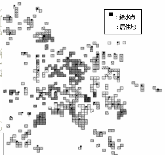
図 - 2 給水点の設置パターン
