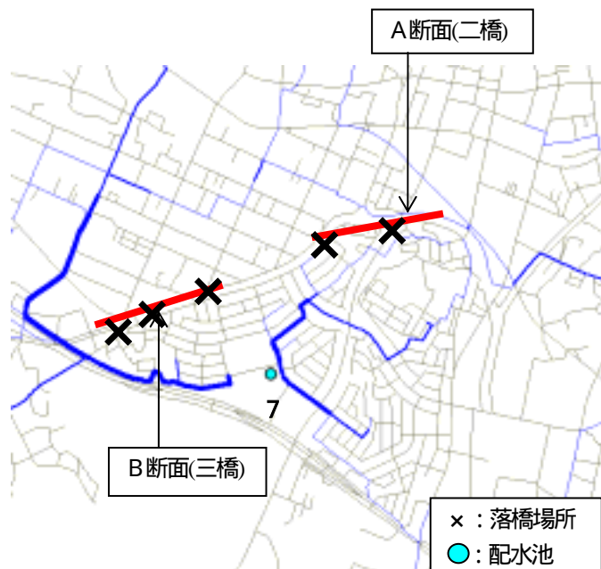
図 - 6 A、B断面で落橋した場合の巡回の様子
